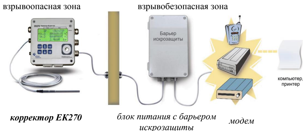
Рисунок 1. Схема подключения вторичного оборудования к ЕК270 во взрывоопасной зоне
